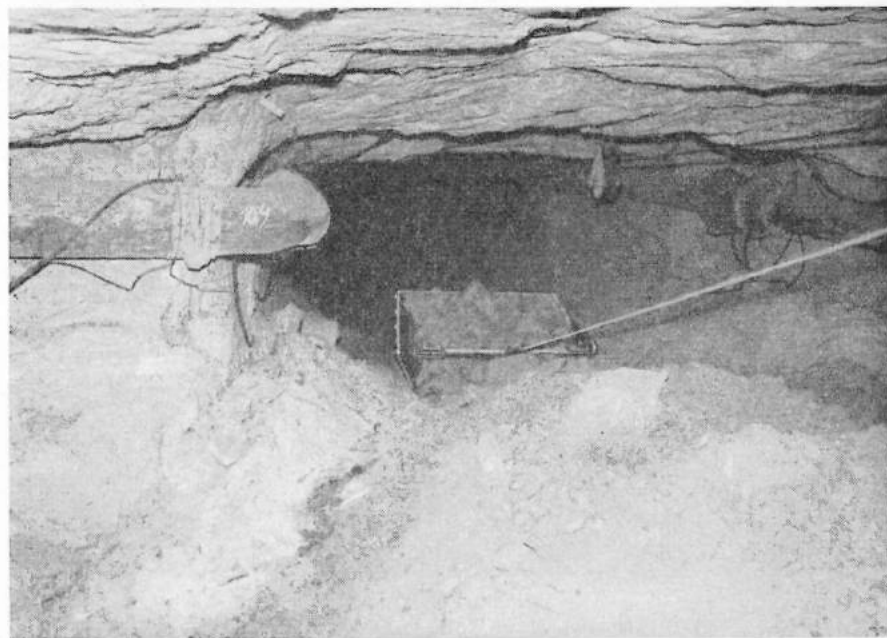
Im Kaliwerk: Mit dem Schrapper wird das losgeschossene Kalirohsalz zur Füllstelle gezogen
