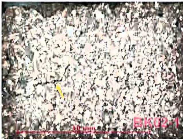
Bild A4.13: Anschlifffläche des Teilabschnittes 1 des Querschnittes (Oberfläche oben im Bild) der Natursteinprobe O-BK2 (rotbrauner Sandstein); siehe Bild A4.11
