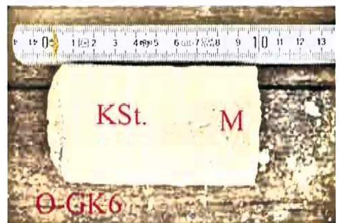
Bild A3.9: Bohrkern O-BK6 (Ø 70 mm): An der Oberfläche im Fugenbereich (links im Bild) war nur eine dünne Schicht Mörtel vorhanden. In der Fuge selbst war auch nur sehr wenig Mörtel („M“) enthalten. Die Bohrung wurde als O-BK6A wiederholt.
