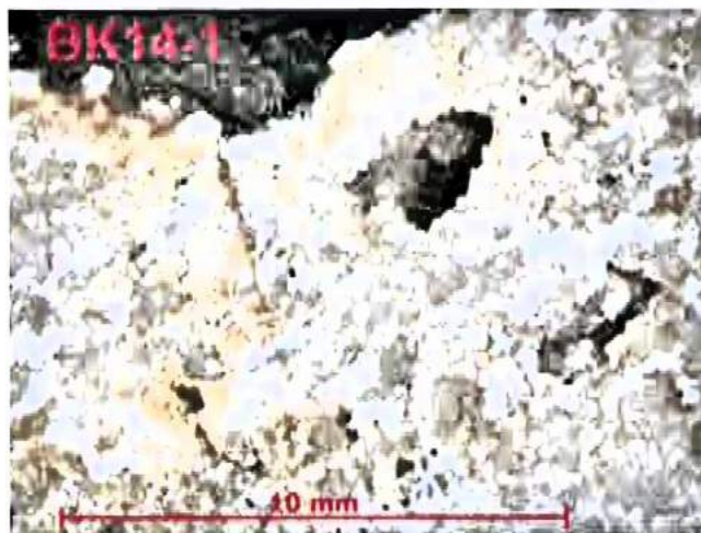
Bild A4.7: Anschließfläche des Teilabschnittes 1 des Querschnittes (Oberfläche oben im Bild) der Natursteinprobe N-BK14: Die Struktur des Steines ist sehr heterogen. Neben dichteren Bereichen befinden sich scheinbar (weiß bis gelblich) lockere Strukturen. Sichtbar sind auch größere Poren. Nach den sichtbaren Strukturen ist von einem erhöhten Wasseraufnahmevermögen bei Schlagregeneinflüssen auszugehen. An der Oberfläche aufliegende starke Verschmutzungen scheinen den Wasserzutritt aktuell etwas zu mindern.
