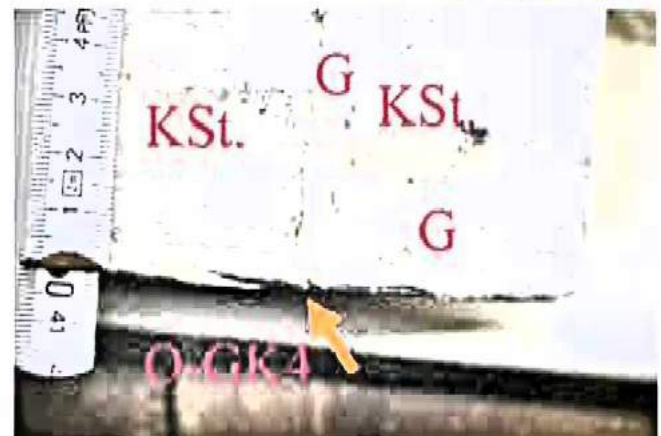
Bilder A3.6 und A3.7: Bohrkern O-BK4 (Ø 110 mm): An der Oberfläche als homogener Naturstein angenommen, stellte sich nach der Entnahme des Kernes heraus, dass mehrere Kalksteinstücke („KSt.“) mit einem Gipsmörtel („G“) verbunden sind. Die Mörteloberfläche ist an die Oberfläche des Kalksteines glatt angearbeitet.
