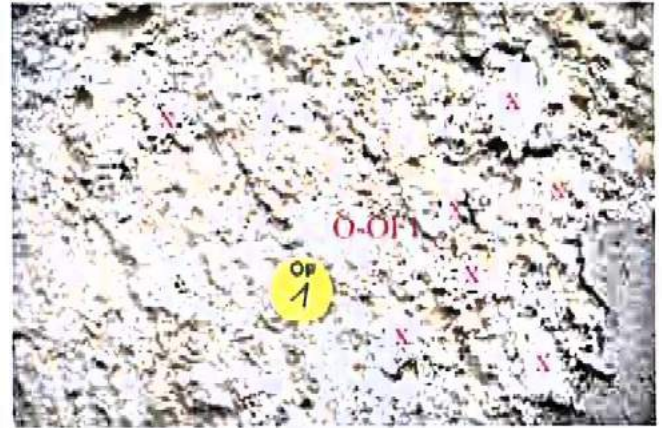
Bild A2.12: Entnahmestelle O-OF1 wenige cm über der Stelle O-BK5: Auf der Natursteinoberfläche sind Reste einer Beschichtung (mit „x“ gekennzeichnet) erkennbar. Von diesen wurde Probenmaterial entnommen.
