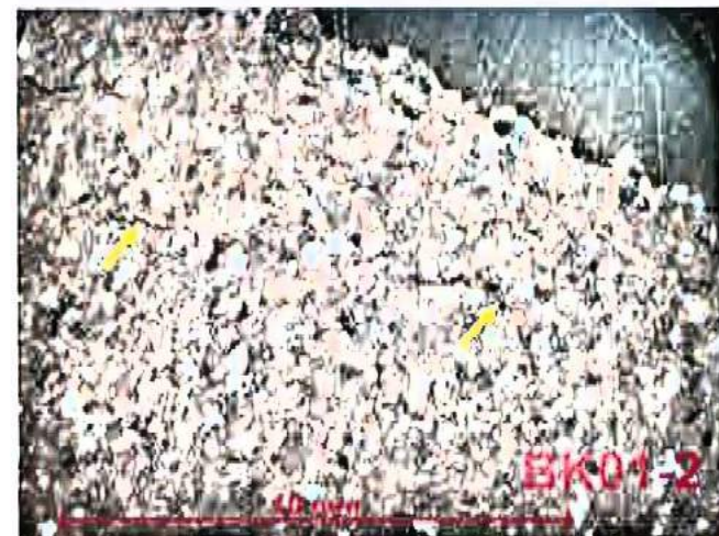
Bild A4.12: Anschlifffläche des Teilabschnittes 2 des Querschnittes (Oberfläche oben im Bild) der Natursteinprobe O-BK1 (rotbrauner Sandstein); siehe Bild A4.11
