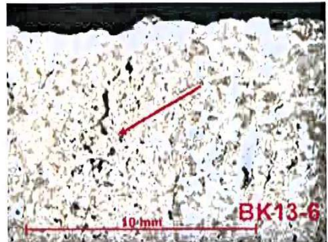
Bild A4.6: Anschließfläche des Teilabschnittes 4 des Querschnittes (Oberfläche oben im Bild) der Natursteinprobe N-BK13: Der Porenanteil ist noch etwa größer als im vorherigen Bild. Das Gesamtpräparat hatte eine Länge von 10 cm. Die dargestellten Strukturen wechseln untereinander im Abstand weniger cm.
