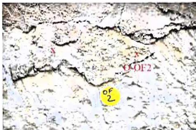
Bilder A2.15 und A2.16: Die Probe O-OF2 (Entnahmestelle mit „x“ gekennzeichnet) wurde aus einer neben der Fuge auf der Steinoberfläche aufliegenden dünnen Mörtelschicht entnommen. Darüber befindet sich eine jüngere Verfugung, die im Rahmen von Reparaturmaßnahmen ausgeführt wurde. Das Material in der Probe muss danach älter sein.
