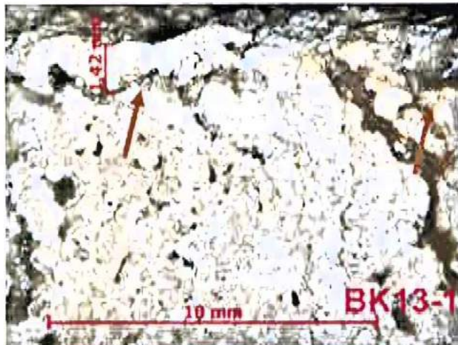
Bild A4.1: Anschlifffläche des Teilabschnittes 1 des Querschnittes (Oberfläche oben im Bild) der Natursteinprobe N-BK13; Von der Oberfläche beginnen sich bis zu 1,5 mm dicke Schichten abzuschalen. Rissartige Hohlräume sind mit bräunlichem Material gefüllt. (mit Pfeilen gekennzeichnete Stellen – siehe nachfolgende Bilder mit Detailansichten) Im Stein ist mehr Hohlräumigkeit vorhanden als von den Steinoberflächen zu erwarten wäre.
