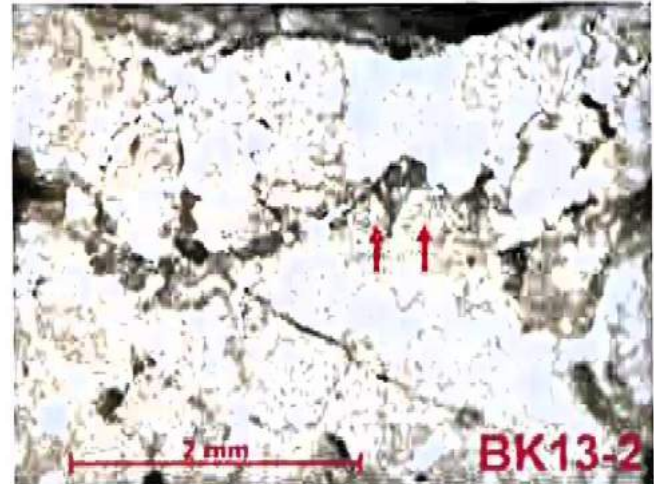
Bild A4.2: Detail 1 zu Bild A4.1: In die scheinbar beginnende Abschalung sind gut ausgebildete Kristalle (Pfeile) hineingewachsen. Somit war der Abriss mit hoher Wahrscheinlichkeit bereits im Ausgangsmaterial vorhanden und ist nicht während der Nutzung im Einbauzustand entstanden. die oberflächennahen Strukturen des hier dargestellten Steines erlauben einen schnellen Wassereintrag bei Schlagregenereignissen.
