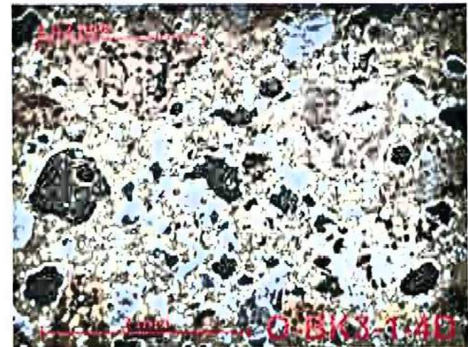
Bild A4.43: Detail 3 – untere Mörtelschicht – zu Bild A4.40: Die Gesteinskörnungen erreichen ein Größtkorn von etwa 2 mm und enthalten hohe Anteile unterschiedlicher farbiger Gesteinskrönungen. Damit unterscheidet sich der Mörtel signifikant vom Mörtel darüber. (siehe auch Bild A4.41)
