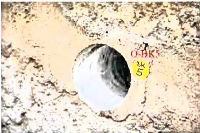
Bild A2.11: Entnahmestelle der Bohrkernprobe O-BK5: An der Probenahmestelle deutete die Verfugungsbreite eine sehr breite dahinter liegende Fuge an. Es war aber nur eine sehr schmale Mörtelfuge im Mauerwerk vorhanden.
