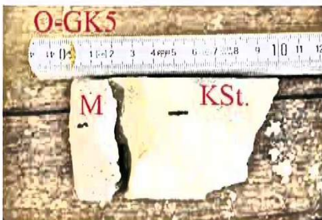
Bild A3.8: Bohrkern O-BK5 (Ø 70 mm): Die Fuge war mit einem zementhaltigen Mörtel verschlossen. Durch rotbraune Gesteinskörnungen im Mörtel entsteht eine entsprechende Eigenfarbe.
