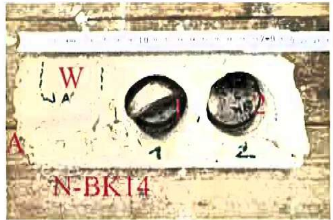
Bild A3.17: Bohrkern O-BK14 (Ø 110 mm): Zur Ermittlung von Orientierungswerten für die Druckfestigkeit wurden zwei kleine Bohrkern (Ø 50 mm) quer entsprechend der Einbausituation (Belastungsrichtung) am Objekt herausgebohrt. Aus dem vorderen Teil („W“) des Kernes ist eine Steinscheibe zur Ermittlung der kapillaren Wasseraufnahme herausgesägt worden.
