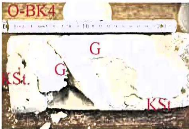
Bilder A3.6 und A3.7: Bohrkern O-BK4 (Ø 110 mm): An der Oberfläche als homogener Naturstein angenommen, stellte sich nach der Entnahme des Kernes heraus, dass mehrere Kalksteinstücke („KSt.“) mit einem Gipsmörtel („G“) verbunden sind. Die Mörteloberfläche ist an die Oberfläche des Kalksteines glatt angearbeitet.
