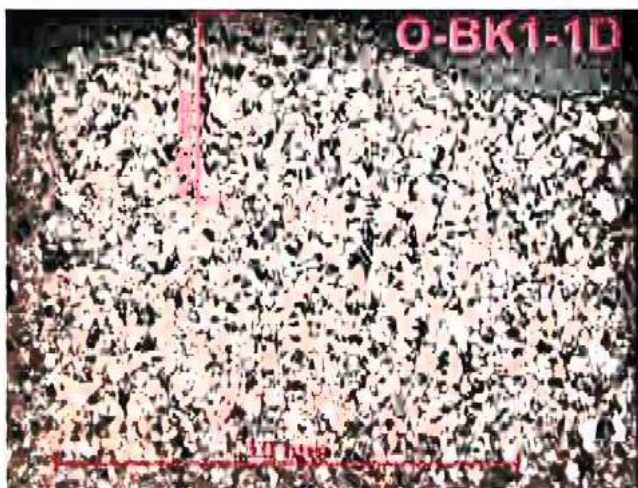
Bild A4.15: Dünnschliffpräparat aus dem rotbraunen Sandstein der Probe O-BK1: Bis zu Tiefen von etwa 4 mm sind hier feine, etwa oberflächenparallel verlaufende Risse vorhanden, siehe auch bild A4.16
