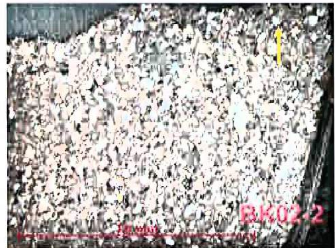
Bild A4.14: Anschlifffläche des Teilabschnittes 2 des Querschnittes (Oberfläche oben im Bild) der Natursteinprobe O-BK2 (rotbrauner Sandstein); siehe Bild A4.11
