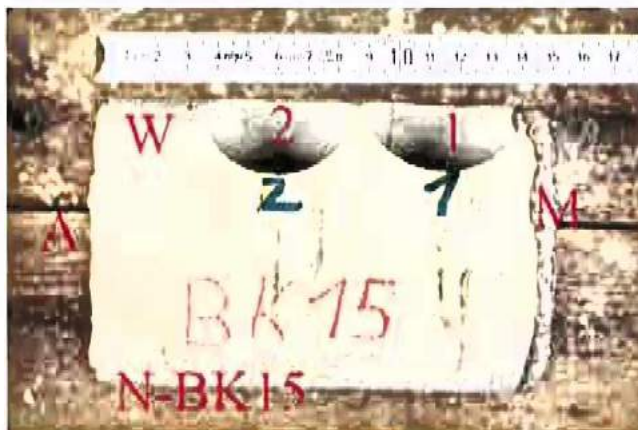
Bild A3.18: Bohrkern O-BK15 (Ø 110 mm): Zur Ermittlung von Orientierungswerten für die Druckfestigkeit wurden zwei kleine Bohrkern (Ø 50 mm) quer entsprechend der Einbausituation (Belastungsrichtung) am Objekt herausgebohrt. Aus dem vorderen Teil („W“) des Kernes ist eine Steinscheibe zur Ermittlung der kapillaren Wasseraufnahme herausgesägt worden.
