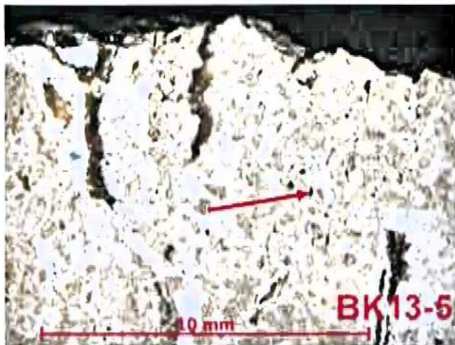
Bild A4.5: Anschließfläche des Teilabschnittes 3 des Querschnittes (Oberfläche oben im Bild) der Natursteinprobe N-BK13: Breitere Risse (teils mit Material gefüllt) sind oberflächennah vorhanden. Auffällig ist auch die partiell vorhandene größere Porigkeit (Pfeil).
