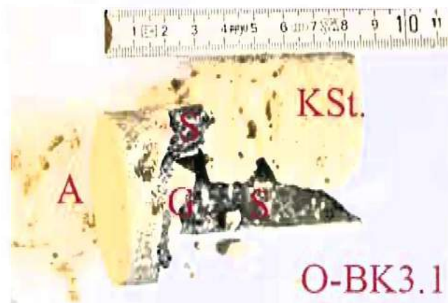
Bild A3.2: Bohrkern O-BK2 (Ø 110 mm): Zur Ermittlung von Orientierungswerten für die Druckfestigkeit wurde ein kleiner Bohrkern (Ø 50 mm) quer entsprechend der Einbausituation (Belastungsrichtung) am Objekt herausgebohrt. Aus dem vorderen Teil des Kernes („A“) ist eine Steinscheibe zur Ermittlung der kapillaren Wasseraufnahme herausgesägt worden.
