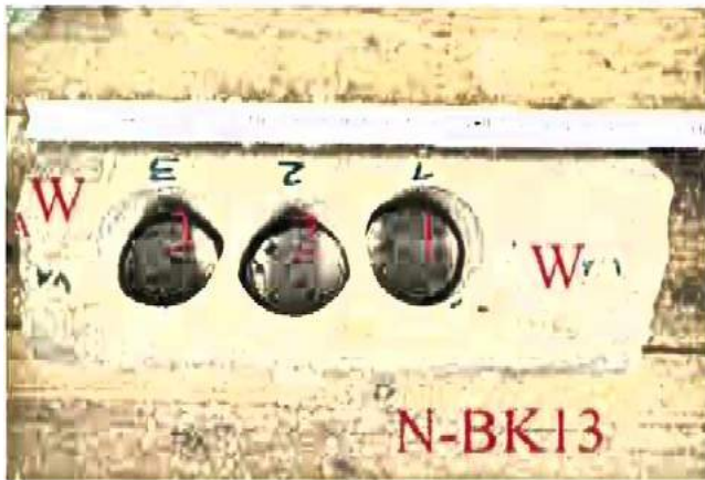
Bild A3.16: Bohrkern O-BK13 (Ø 110 mm): Zur Ermittlung von Orientierungswerten für die Druckfestigkeit wurden drei kleine Bohrkern (Ø 50 mm) quer entsprechend der Einbausituation (Belastungsrichtung) am Objekt herausgebohrt. Aus dem vorderen und hinteren Teil („W“) des Kernes sind Steinscheiben zur Ermittlung der kapillaren Wasseraufnahme herausgesägt worden.
